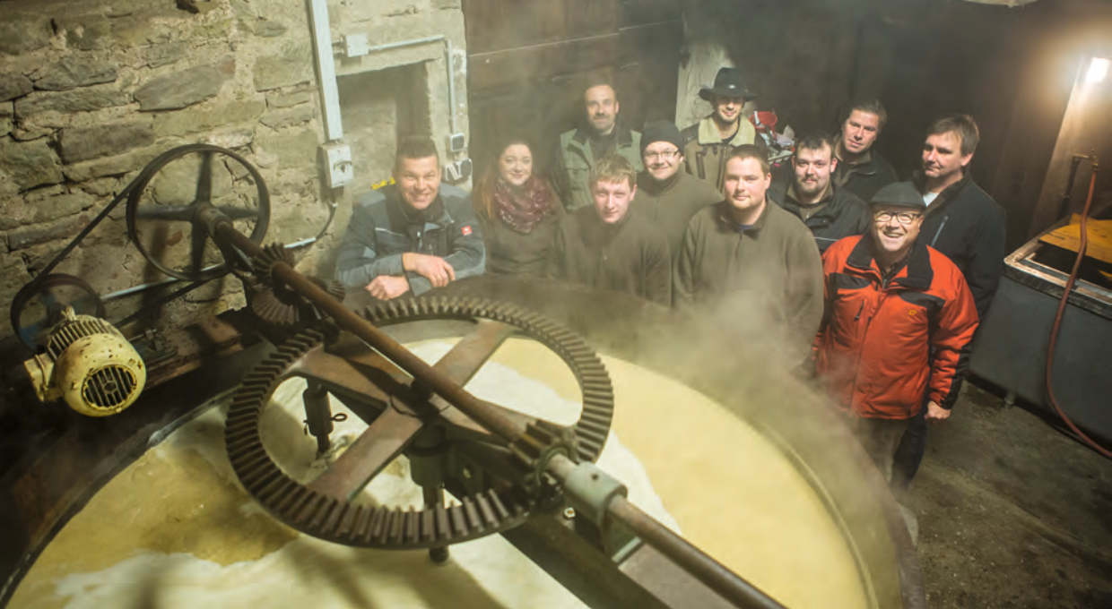
Gelebte Braukultur im unterfränkischen Junkersdorf: der über 100 Jahre alte Läuterbottich des Kommunbrauhauses wird regelmäßig genutzt
